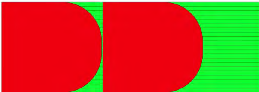
Рисунок 2.1 – Схема раскроя листов сотового поликарбоната размерами 6x2,1 м для покрытия торцов каркаса теплицы
