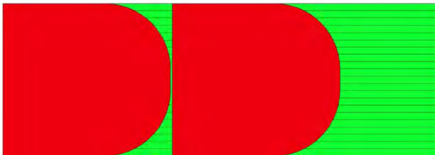
Рисунок 2.1 – Схема раскроя листов сотового поликарбоната размерами 6х2,1 м для покрытия торцов каркаса теплицы
