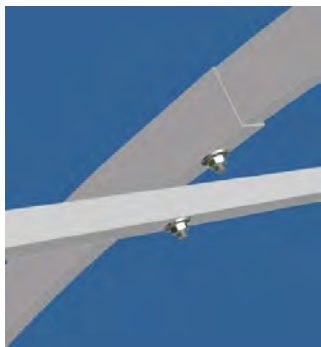
Рисунок 3.1 – Вид взаиморасположения дуг и поперечин при их соединении
