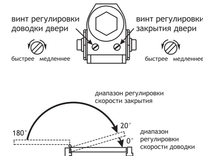
Закрытие и доводка регулируются 2 винтами. Сначала отрегулируйте скорость закрытия, далее скорость доводки двери. Обозначение регулировок винтов указаны на обратной стороне доводчика LATCH - скорость доводки CLOSING - скорость закрытия Внимание! От закрученного состояния винт нельзя раскручивать более чем на 5 оборотов - это приведет к вытеканию масла. Скорость закрытия регулируется оборотом винта:
