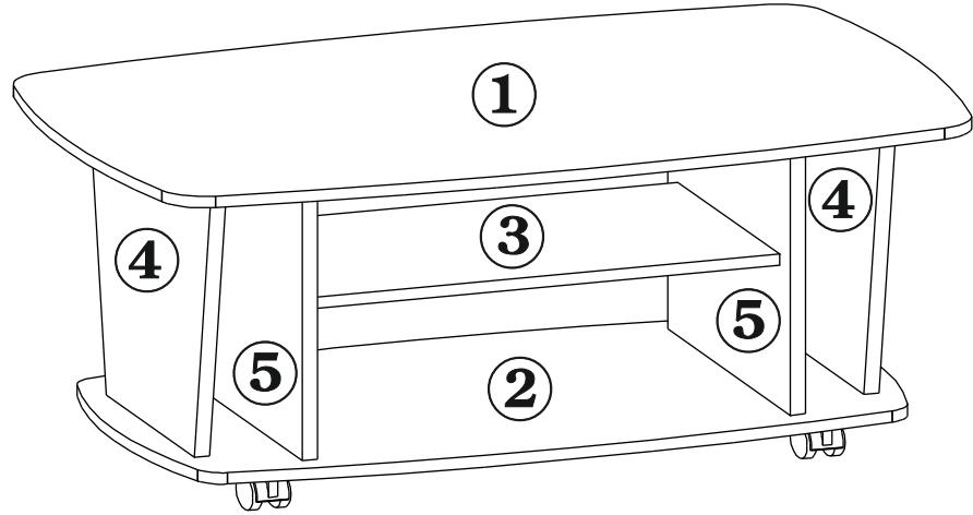
3.1. Соедините боковины (дет№5) и полку (дет№3) с помощью винтовой стяжки (поз.А) и шкантов (поз.Г). Вставьте В отверстия в боковинах (дет№ 4 и 5) эксцентрики (поз.В).
