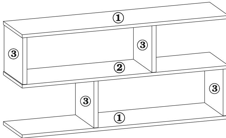
3.2. К детали №2 присоедините две детали №3 сверху при помощи Винтовой стяжки. Аналогичным способом закрепите две детали №3 расположив их снизу детали №2.
