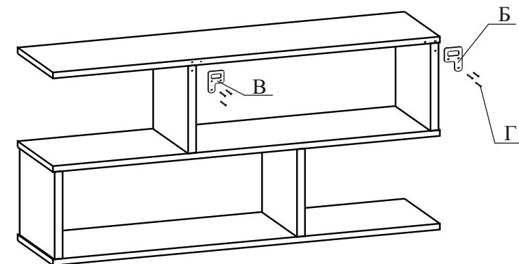
3.5.Разметьте место на стене для навески полки. Просверлите отверстия, забейте дюбеля, закрутите шурупы 4x40, повесьте изделие.
