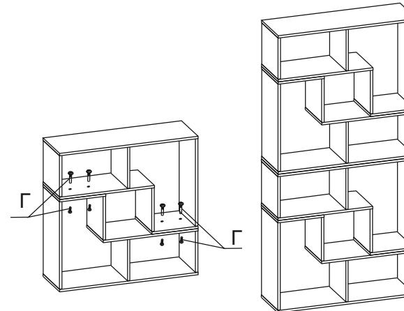
3.5. В целях безопасности рекомендуется закрепить конструкцию к стене при помощи монтажного уголка (поз.Е), И прилагаемых шурупов 4x16 и 4x40. Предварительно просверлив в стене отверстие диаметром 6 мм, и забив туда пластиковый дюбель.
