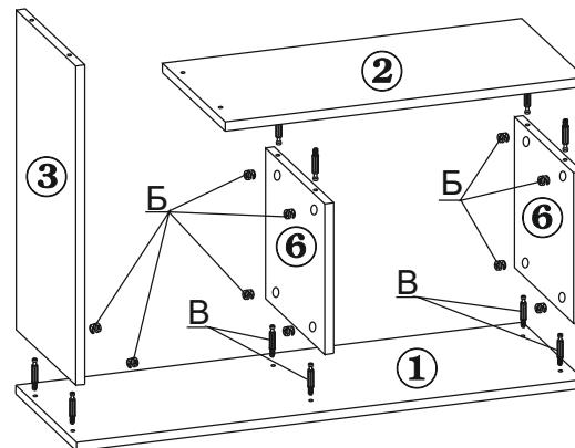
3.3. Закрепите боковину (дет.№5) к полке (дет.№2) при помощи винтовой стяжки (поз.А). В крышку (дет.№4), вкрутите штоки эксцентриков (поз.В). В детали №5 и №3, установите эксцентрики. Установите деталь №4, на детали №3 и №5 так чтобы штоки эксцентриков вошли в торцевые отверстия. Зафиксируйте эксцентрики повернув их на 180 градусов по часовой стрелке. На деталь которая будет являться дном полки, установите опоры (поз.Д), закрепив их шурупами 4x25 (поз.И), примерно в 40 мм от углов детали.
