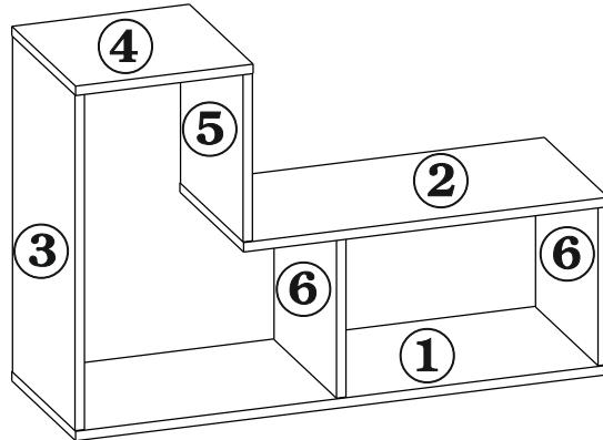
3.2. В Основание (дет.№1) и полку (дет.№2), вкрутите штоки эксцентриков (поз.В). В перегородки (дет.№6) и боковину (дет.№3) установите эксцентрики (поз.Б). Соедините детали, так чтобы штоки эксцентриков вошли в торцевые отверстия. Зафиксируйте эксцентрики повернув их на 180 градусов по часовой стрелке.
