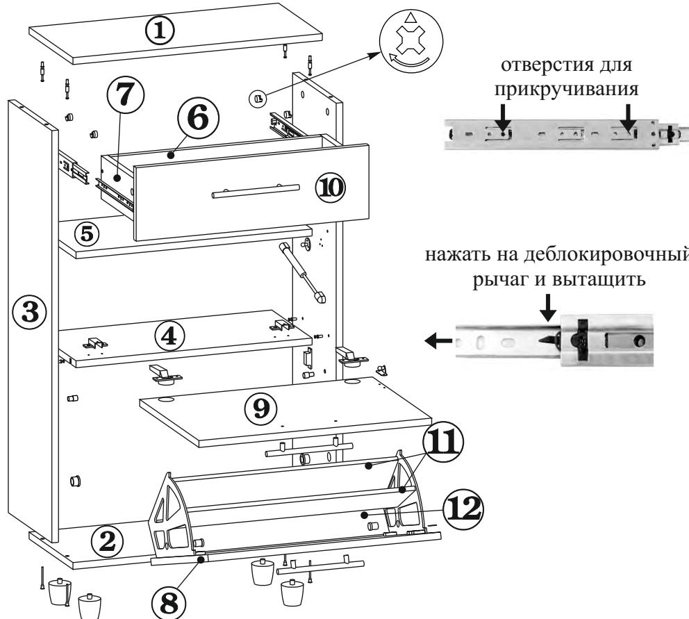
1. В отверстия на боковинах (дет.№3) вставьте втулки кронштейнов, ограничители и эксцентрики. **Обратите внимание: стрелка на эксцентрике должна быть направлена к верхнему торцу детали.** Закрепите крепежную площадку для крепления газового лифта. В отверстия на боковинах (дет.№№ 1) закрутите ввинчивающиеся дюбели. Шурупами 4x16 закрепите шариковые направляющие .Шурупами 3x20 закрепите магнитные защелки. На полке (дет.№4) шурупами 4x16 закрепите ответные части 4-х шарнирных петель.
