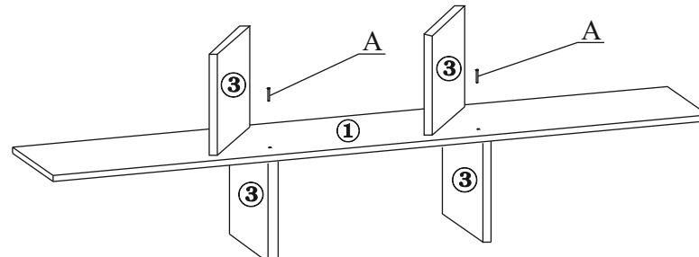
3.3. Установите крайние левую и правую детали №3, затем верхнюю и нижнюю деталь №2. Закройте головки винтовых стяжек декоративными заглушками.
