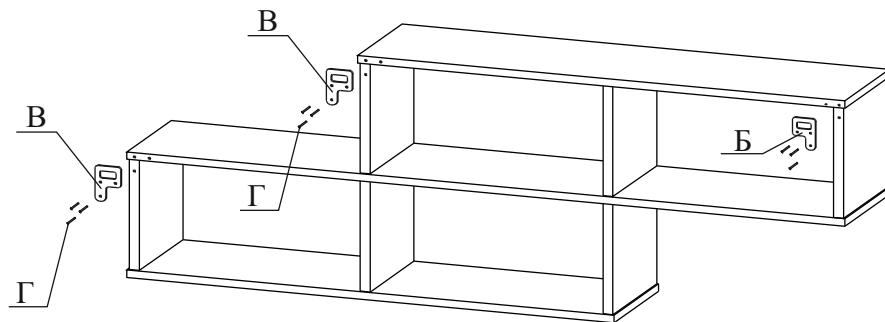
3.5.Разметьте место на стене для навески панели. Просверлите отверстия, забейте дюбеля, закрутите шурупы 4x40, повесьте изделие.
