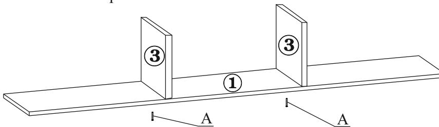
. 3.3. Разверните детали №3 приблизительно на 25 - 30 градусов, так чтобы обеспечить доступ к отверстиям для крепления двух деталей №3 снизу
