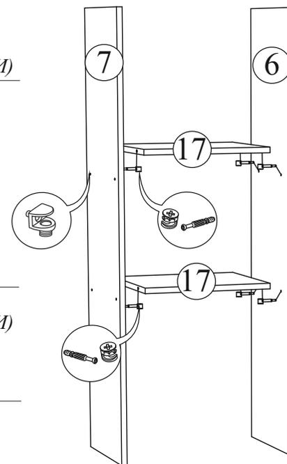
Монтаж эксцентриковой стяжки
