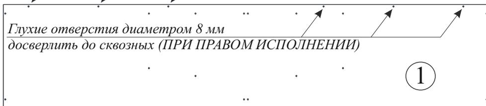
Глухие отверстия диаметром 8 мм
