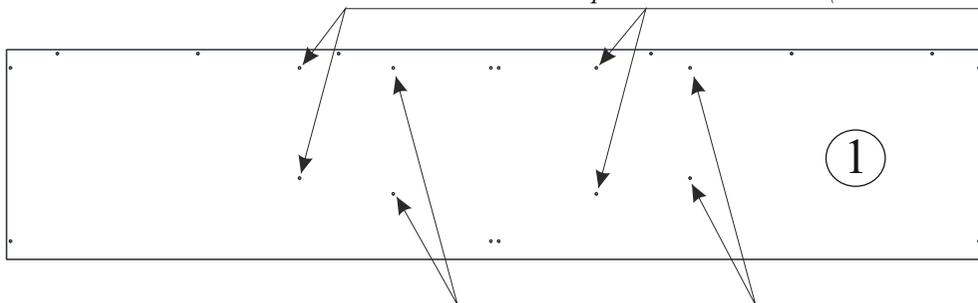
Глухие отверстия диаметром 8 мм
