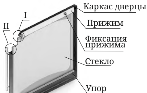
Рисунок 10. Ремонт светорозрачного экрана дверцы модификации «Витра»
