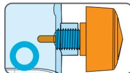
Положение рычажка неверное, поэтому детали кресла не зафиксированы.
