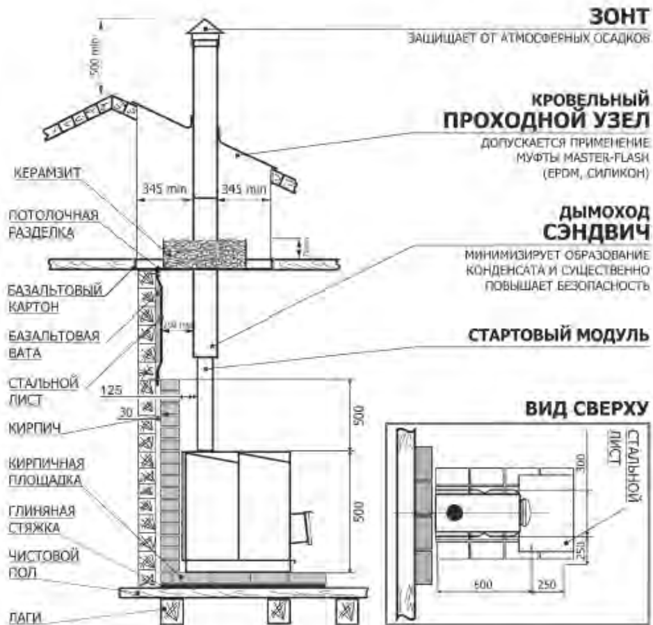
Рисунок 2 — Монтаж печи серии Т (1.1)
