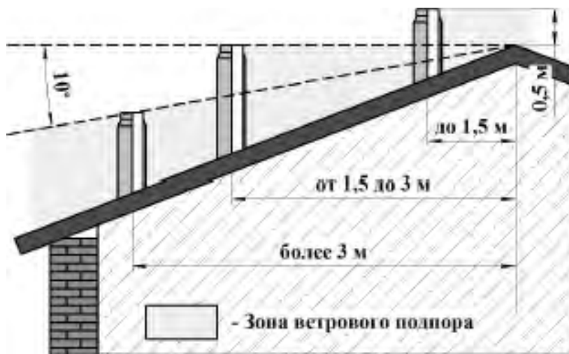
Рисунок 3 — Требования к высоте дымохода
