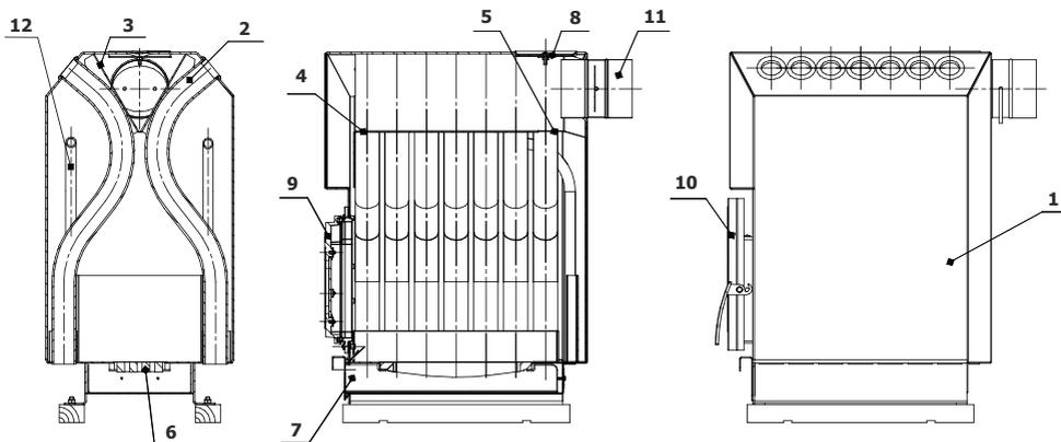
**Рис. 4** 1 — топка, 2 — конвективные трубы, 3 — канал дымохода, 4,5 — прочистные щели, 6 — колосник чугунный, 7 — ящик зольника, 8 — бигель с крышкой дымоборника, 9 — чугунная дверца, 10 — стальная дверца, 11 — шибер поворотный, 12 — каналы подачи воздуха для вторичного дожига
