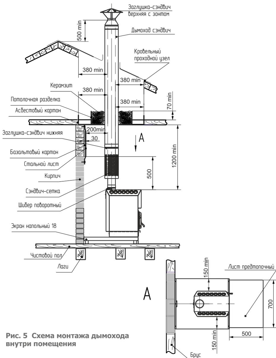
Рис. 5 Схема монтажа дымохода внутри помещения
