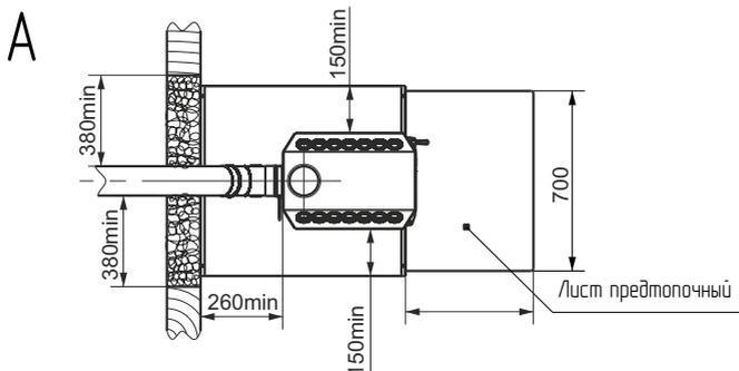
Рис. 6 Схема монтажа дымохода снаружи помещения
