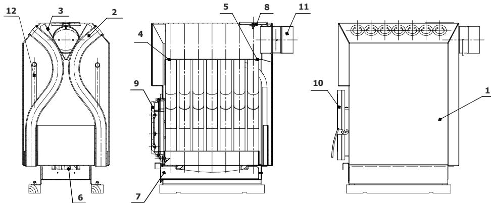
**Рис. 4** 1 — топка, 2 — конвективные трубы, 3 — канал дымохода, 4,5 — прочистные щели, 6 — колосник чугунный, 7 — ящик зольника, 8 — бигель с крышкой дымосборника, 9 — чугунная дверца, 10 — стальная дверца, 11 — шибер поворотный, 12 — каналы подачи воздуха для вторичного дожига
