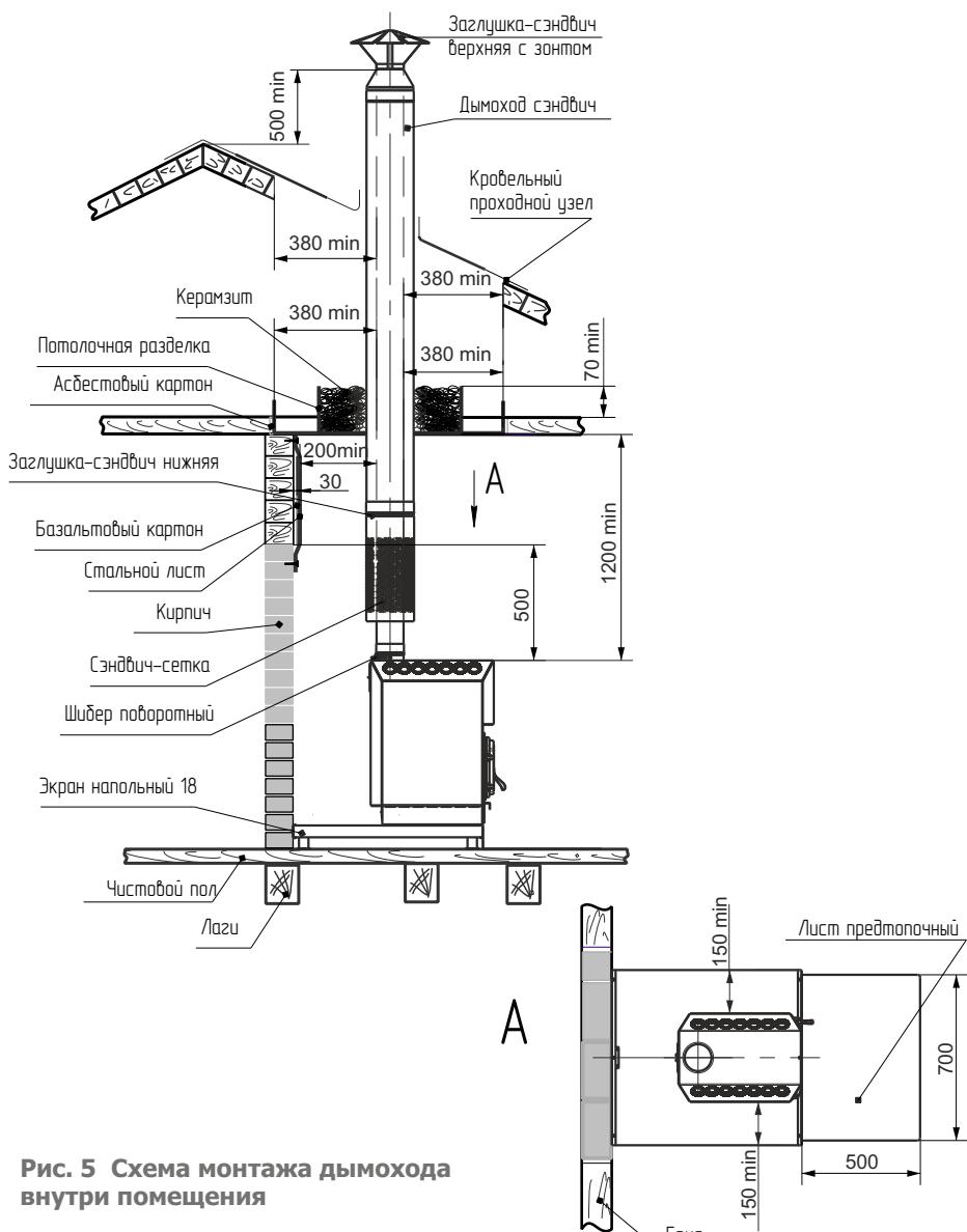
Рис. 5 Схема монтажа дымохода внутри помещения
