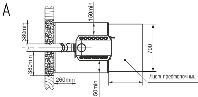
Рис. 6 Схема монтажа дымохода снаружи помещения
