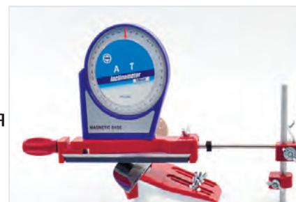
$$\begin{array}{lcl} \text{требуемый} & = & \text{угол наклона} \\ \text{угол заточки} & & \text{основания } 20^\circ \end{array} \quad + \quad \text{угол по угломеру}$$
