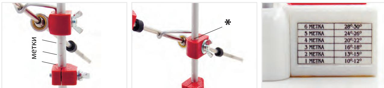
Переместите шаровой шарнир вдоль стойки шарнира до метки соответствующей желаемому углу заточки. Метка угла должна располагаться по верхней части корпуса шарнира\*. Затяните фиксирующий барабашек.
