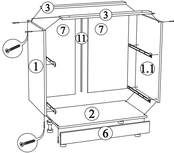
Опоры кухонные по наклонам прикрутить с помощью шурупов 3,5x16 к крышке (деталь № 3).
