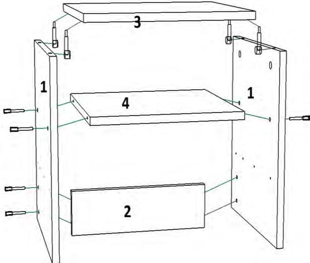
К боковине 1 гвоздями прибить подпятники и шурупами 3,5\*16 привернуть направляющие колесом вперед. Еврошурупами скрутить детали 1,2 и 4, как показано на рисунке. В готовые отверстия детали 3 ввернуть винты эксцентриков и установить крышку на боковину, стянув замками.
