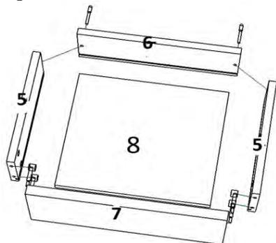
Еврошурупами скрепить детали 5 и 6, в пропил вставить ЛДВП. В готовые отверстия детали 7 ввернуть эксцентрики и закрепить фасад на корпус ящика стянув замками. К нижней части ящика привернуть шурупами 3,5\*16 направляющие колесом назад. Вкатить ящик в корпус тумбы.
