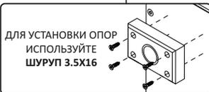
ДЛЯ УСТАНОВКИ ОПОР ИСПОЛЬЗУЙТЕ ШУРУП 3.5X16
