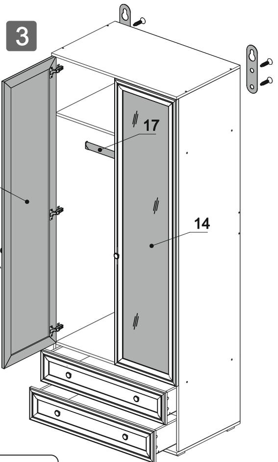
ДЛЯ УСТАНОВКИ НАПРАВЛЯЮЩИХ ИСПОЛЬЗУЙТЕ РЕГУЛИРОВОЧНЫЕ ОТВЕРСТИЯ, А ТАК ЖЕ ШУРУП 3.5X16
