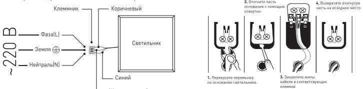
Рис.1. Схема подключения светильника SPO-6-48 к сети 220В.
