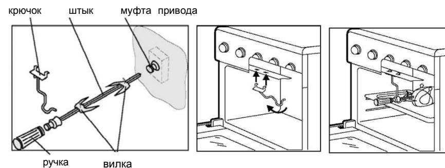
Рисунок 11 – Схема установки вертела
