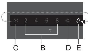
При превышении допустимой температуры в приборе включается прерывистый звуковой сигнал и мигает индикатор **E**.
