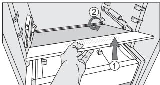
2. Затем извлеките полку. Для этого максимально приподнимите переднюю часть полки, извлеките полку из гнезд на задней стенке и потяните на себя.
