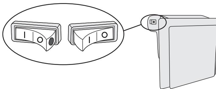
Когда ионизатор воздуха включен, на выключателе видна красная точка.
