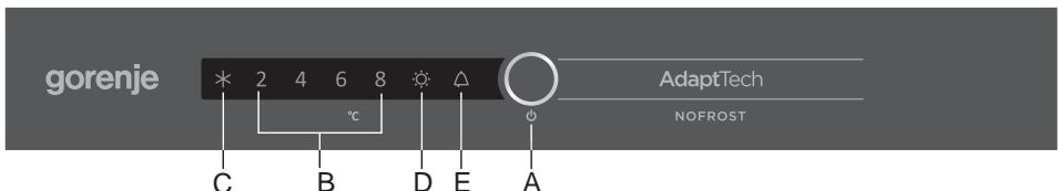
**А Кнопка вкл./выкл. прибора, установки температуры и дополнительных функций**
