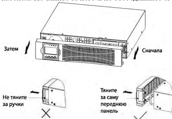
Рис. 5 Снятие передней крышки блока АКБ
