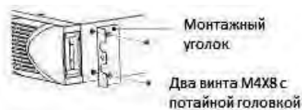
Рис.3 Установка монтажных уголков
