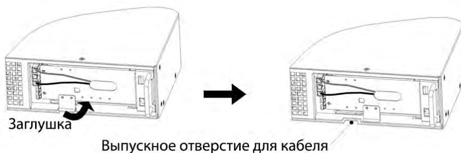
Рис. 6 а Удаление заглушки выпускного отверстия в ИБП.
