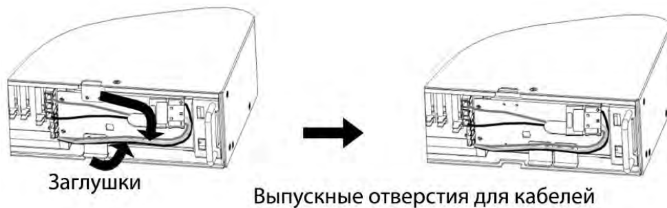
Рис. 6 б Удаление заглушки выпускного отверстия в ДВББ.
