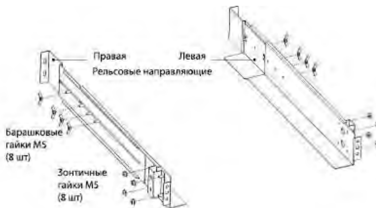
Рис.1 Крепление рельсовых направляющих
