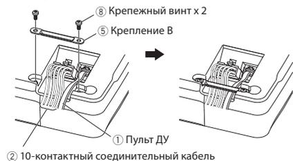
Подключите 10-контактный соединительный кабель 2 и пульт ДУ 1 к колонке.
