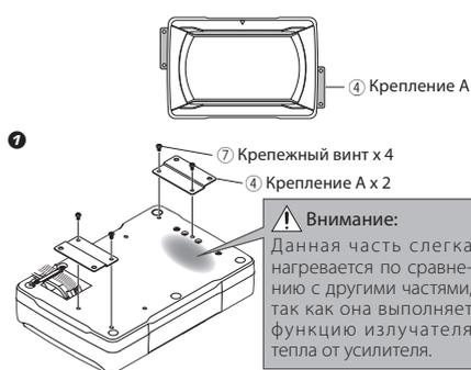
Надежно прикрепите крепления А 4 к колонке с помощью крепежных винтов 7. Соблюдайте предосторожность, и не давайте подключенным кабелям оставаться между колонкой и креплениями А 4.
