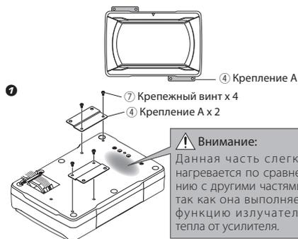
Надежно прикрепите крепления А 4 к колонке с помощью крепежных винтов 7. Соблюдайте предосторожность, и не давайте подключенным кабелям оставаться между колонкой и креплениями А 4.
