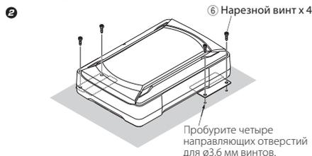
Пробурите направляющие отверстия для  $\varnothing 3,6$  мм винтов на участке листового металла автомобиля, и с помощью шурупов прикрепите колонку к автомобилю 6.
