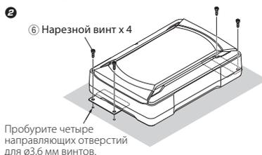
Пробурите направляющие отверстия для  $\varnothing 3,6$  мм винтов на участке листового металла автомобиля, и с помощью шурупов прикрепите колонку к автомобилю 6.
