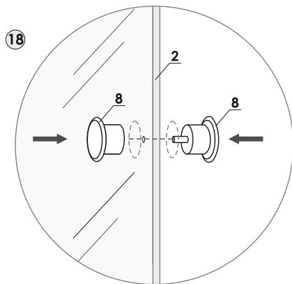
19. Установите магнитный профиль на подвижные стекла в место смыкания (рис.19).
