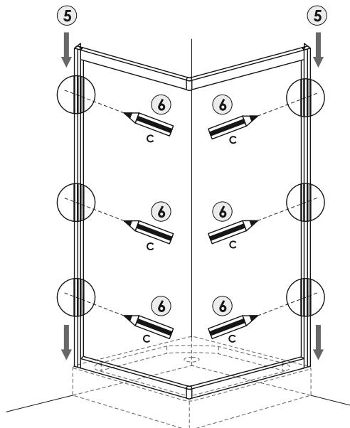
6. Произведите разметку для сверления стен и установочного профиля (рис. 6).
