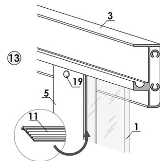
14. В пазы стоечных профилей установите водоотводной уплотнитель крылом внутрь (рис.14). используйте киянку.
