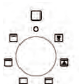
1. КНОПКА ВЫБОРА ФУНКЦИИ Настраивает рабочие позиции духового шкафа
