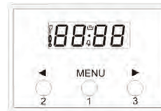
1: Кнопка выбора функции 2: Кнопка «Минус» 3: Кнопка «Плюс» 2 и 3: Ручной режим
