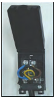
Рис. 2: Электрическое соединение кабеля прибора.
