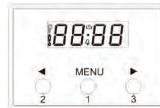
1: Кнопка выбора функции 2: Кнопка «Минус» 3: Кнопка «Плюс» 2 и 3: Ручной режим
