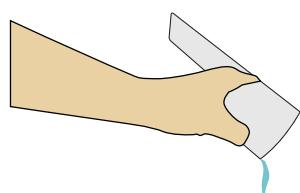
Когда свет сменится на зеленый, устройство готово к работе. Один раз нажать на кнопку-курок на внутренней стороне рукоятки. Устройство начнёт подавать пар. Плотно прижать паровую головку к ткани и провести по ней.
