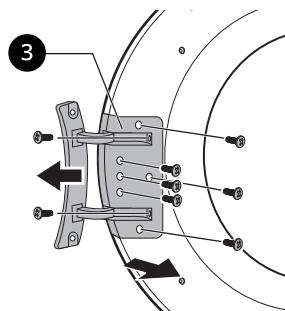
**3** Выверните три винта из защелки **4** дверцы между дверцей и петлей, а затем выверните винт, фиксирующий крюк дверцы.
