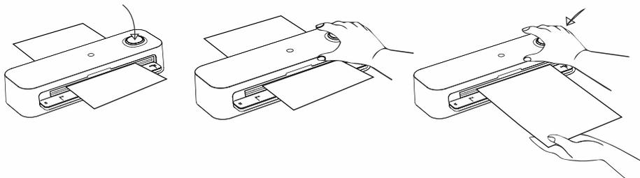
Ламинатор оснащен антиблокировочной системой. Если вы неправильно вставили пленку для ламинирования или она застряла в устройстве, нажмите кнопку ABS, после чего вы можете извлечь пленку с документом из устройства и снова вставить документ в окно для подачи и повторить процесс.
