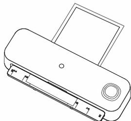
Ламинированные предметы автоматически выходят из ламинатора
