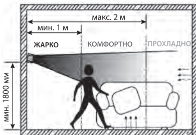
Рис. 4. Распределение тепла в объеме помещения
