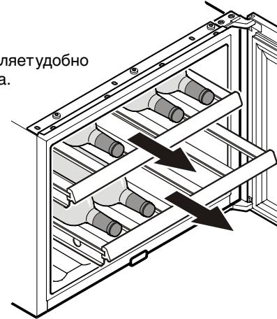
Высокие бутылки вина можно хранить над деревянных полках и поперек. Чтобы обеспечить стабильное положение бутылок, вставьте прилагаемые опорные плиты на среднюю перегородку деревянной полки.
