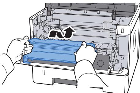
**9 Верните узел проявки вместе с контейнером с тонером в его изначальное положение так, чтобы направляющие с обоих концов совпали с пазами в аппарате.**
