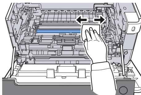
**7 Чтобы очистить кабель наполнителя, переместите устройство для очистки основного наполнителя на барабанном блоке вперед-назад 2 или 3 раза.**
