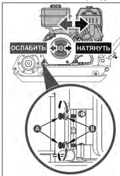
Рис. 31 Регулировка натяжения ремней РС6337F
