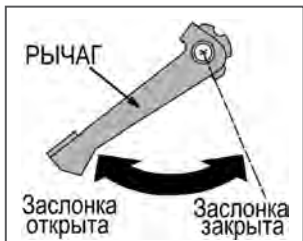
Рис. 14 Рычаг управления воздушной заслонкой PC5332F (вид сверху)
