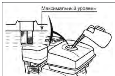
Рис. 13 Максимальный уровень топлива в топливном баке
