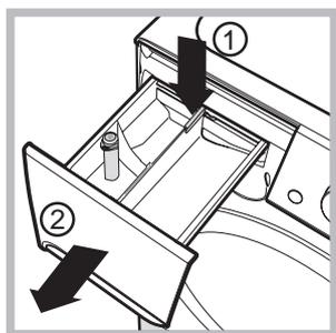
Дозаторду чыгаруу үчүн тилчесин (1) басыңыз жана дозаторду (2) алып чыгыңыз (сүрөттү кара). Чөнөкчөнү агын суу менен жууңуз. Бул операция үзгүлтүксүз аткарылышы керек.
