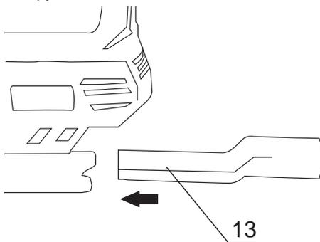
6.5.2 Подключите шланг пылесоса к переходнику и проверьте герметичность подключения.
