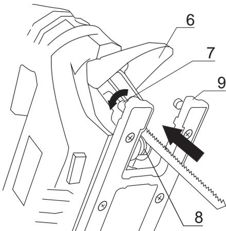
6.1.2 Установите пильное полотно до упора в патрон таким образом, чтобы гладкая кромка полотна входила в паз опорного ролика (8), а режущая кромка (с зубьями) должна быть соответственно направлена в противоположную от опорного ролика сторону.
