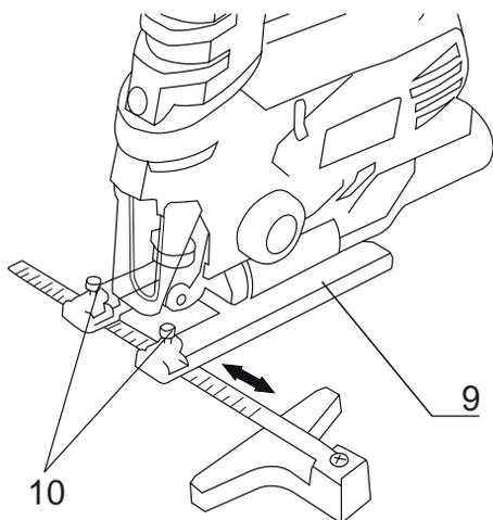
6.4.2 Выставьте необходимую длину параллельного упора и затяните винты фиксации.
