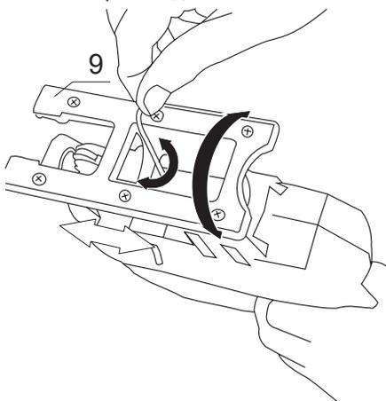
6.2.2 Поверните подошву до нужного угла и затяните винты крепления подошвы шестигранным ключом.
