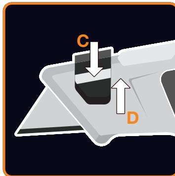
2. Нажмите на кнопку блокировки лезвия (C) и потяните механизм вверх до тех пор, пока лезвие не разблокируется (D).
