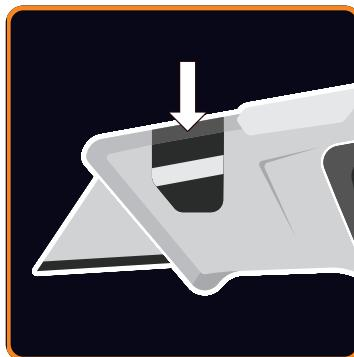
5. Закройте механизм блокировки до характерного щелчка.
