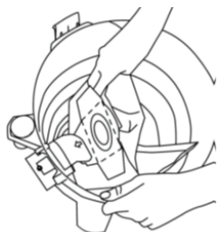
Установка бумажного мешка
