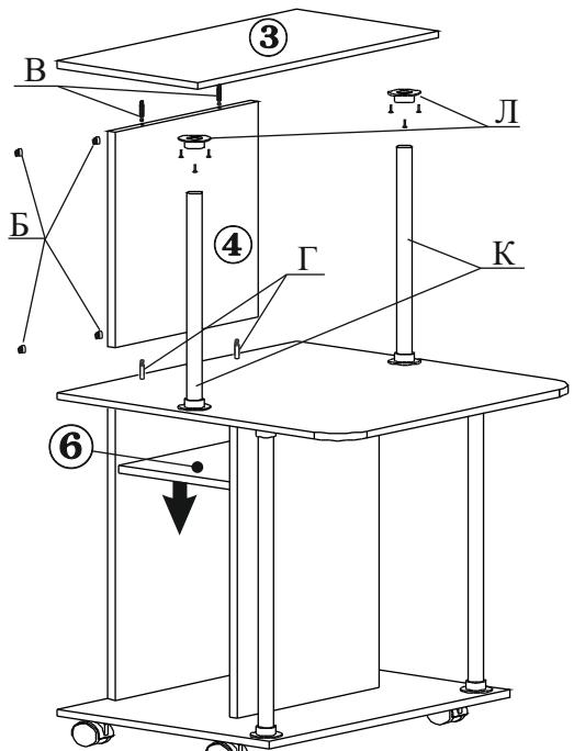
1.4. С нижней стороны полки (дет.№3), вкрутите два штока эксцентрика (поз.В) и установите два фланца (поз.Л). В заднюю стенку (дет№4), с тыльной стороны установите четыре эксцентрика (поз.Б). Установите две трубы (поз.К).
