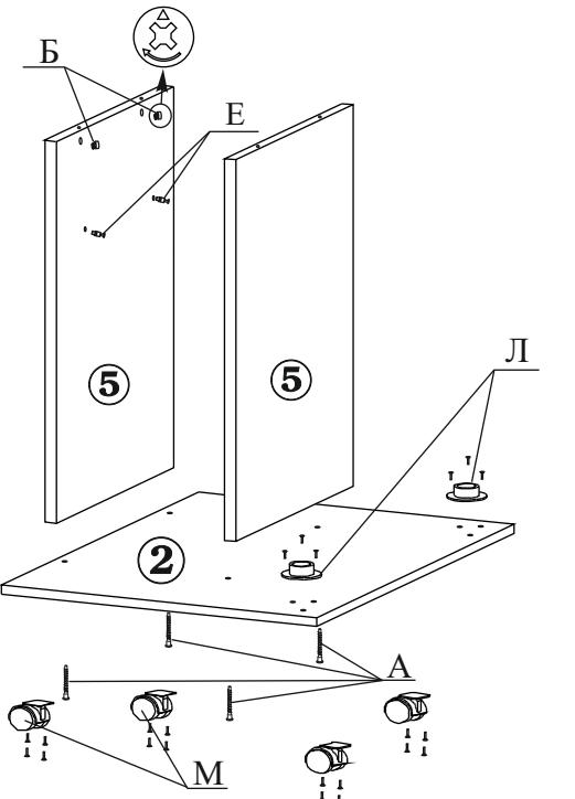
1.1. С нижней стороны основания (дет.№2) установите мебельные колеса (поз.М). В боковины (дет№5) закрутите ввинчиваемые дюбели (поз.Е). Закрепите детали №5 на основании (дет№2). Закрепите винтовыми стяжками (поз.А).
