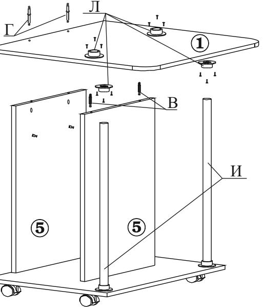
1.3. С нижней стороны столешницы (дет№1) прикрутите два фланца (поз.Л), И два штока эксцентрика (поз.В). Сверху в отверстия в столешнице (дет.№1) вставьте штоки двойных эксцентриков (поз.Г). **Внимание! Двойные штоки, вставляются длинной стороной, относительно стопорной шайбы!**
