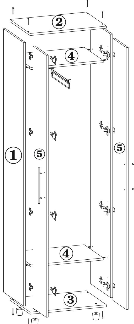
1. Шурупами 4x20 прикрепите к верхней полке (дет.№ 4) выдвижную штангу. К боковым стенкам (дет.№ 1) шурупами 4x16 прикрепите ответные части 4-х шарнирной петли. В отверстия на боковинах (дет.№№ 1) закрутите ввинчивающиеся дюбели. К дверям (дет.№№ 5 ) шурупами 4x16 прикрепите 4-х шарнирные петли для внутренней двери, и прикрутите ручки.
