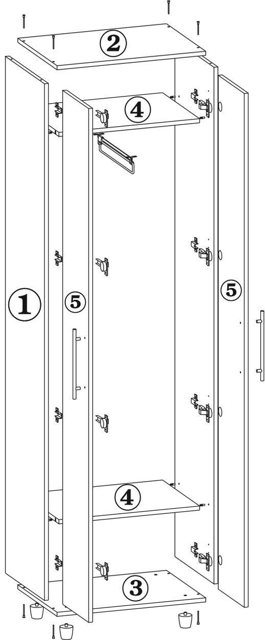
1. Шурупами 4x20 прикрепите к верхней полке (дет.№ 4) выдвижную штангу. К боковым стенкам (дет.№ 1) шурупами 4x16 прикрепите ответные части 4-х шарнирной петли. В отверстия на боковинах (дет.№№ 1) закрутите ввинчиваемые дюбели. К дверям (дет.№№ 5) шурупами 4x16 прикрепите 4-х шарнирные петли для внутренней двери, и прикрутите ручки.
