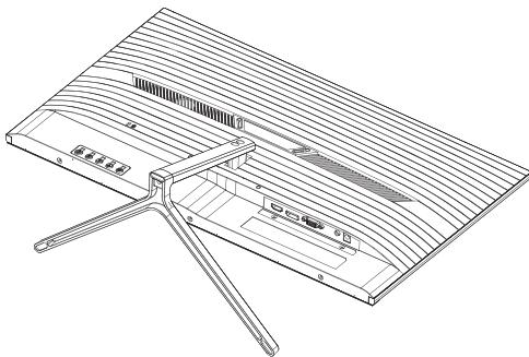
2. Прикрепите винтами корпус подставки к задней части монитора.
