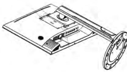
2. Положите монитор на ткань ЖК-панелью вниз, чтобы предотвратить повреждение ЖК-панели.
