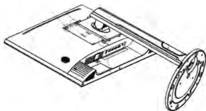
2. Положите монитор на ткань ЖК-панелью вниз, чтобы предотвратить повреждение ЖК-панели.
