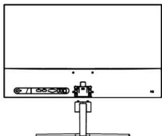
2. Положите монитор на ткань ЖК-панелью вниз, чтобы предотвратить повреждение ЖК-панели. Установите собранный корпус подставки в пазы монитора до характерного щелчка, как показано на рисунке ниже.
