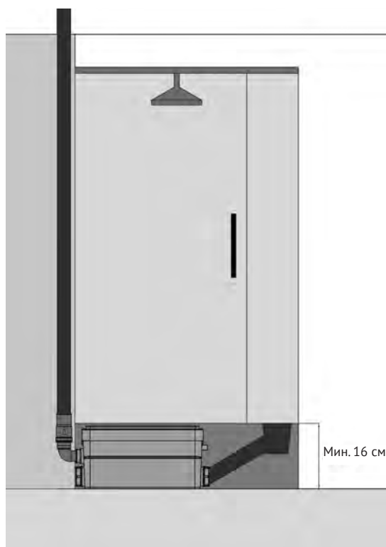
Рисунок 5 – Установка КНС под душевым поддоном
