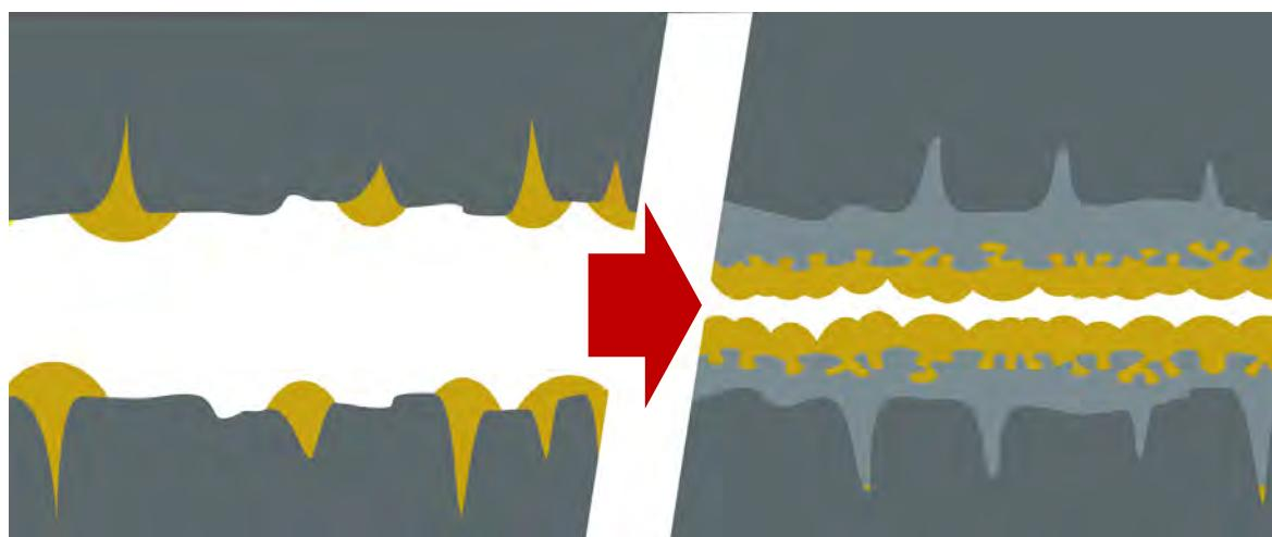
Микропоры защитного слоя наполняются маслом, которое за счет сил поверхностного натяжения образует на нем сплошную пленку. Эта масляная пленка полностью никогда не отделяется от поверхности детали, не стекает, даже при долгом простое. Сам защитный слой способен выдерживать большие нагрузки за счет повышенной микротвердости и микроупругости по сравнению с оригинальной заводской поверхностью.
