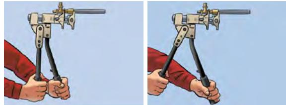
**6** Визуально проверить готовое соединение на отсутствие повреждений.
