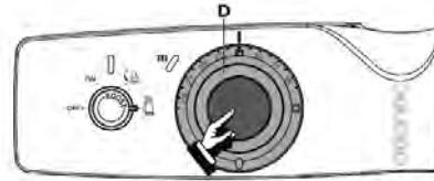
утримуючи його центральну частину. Встановіть зовнішній диск регулятора навпроти значення температури, що відображається на термометрі (положення можна змінювати в діапазоні від -3 °C до +3 °C). Потім поверніть зовнішній диск регулятора у початкове положення. Пристрій почне змінювати температуру до значення 20 °C.
