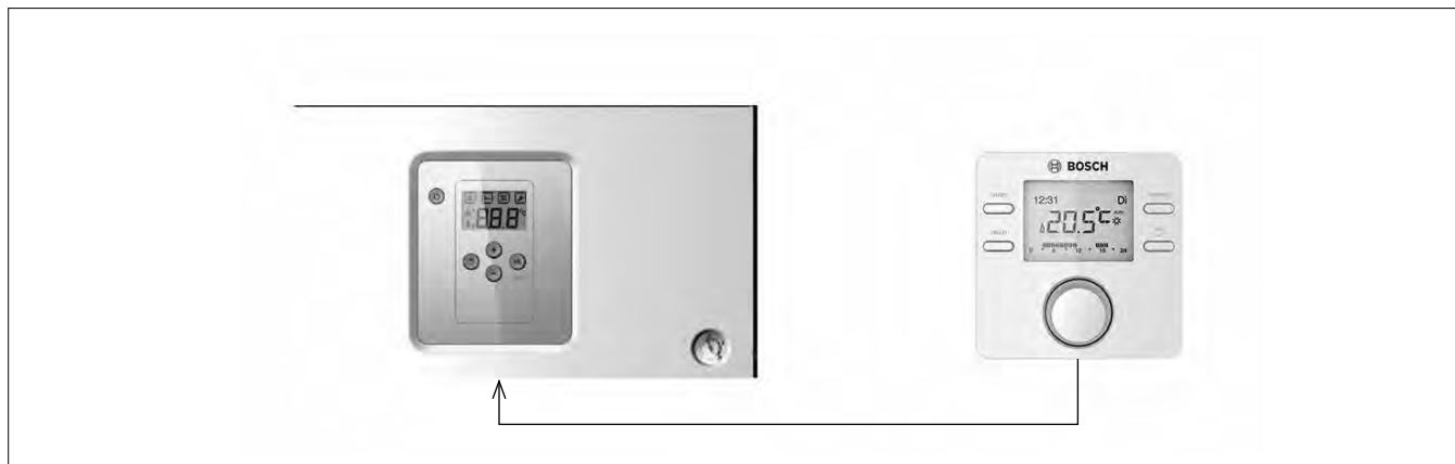
5/1 Комбинация программируемого регулятора комнатной температуры Open-Therm CR50 с панелью управления газового конвекционного котла Gaz 6000 W.
