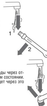
Промойте насадку под углом к струе воды через отверстие в головке насадки во включенном состоянии. Вода, пройдя по головке насадки, выйдет через это же отверстие.
