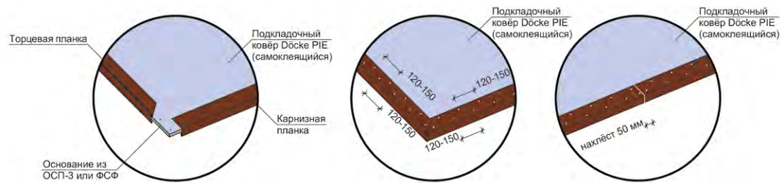
Рис. 13. Крепление металлических карнизных и торцевых планок.
